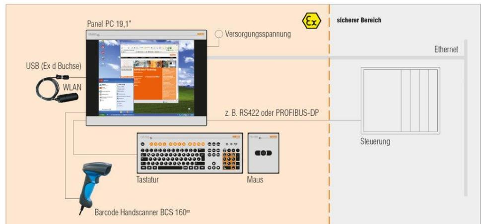
Abbildung 7: Systemaufbau mit Barcodescanner und externer Tastatur
