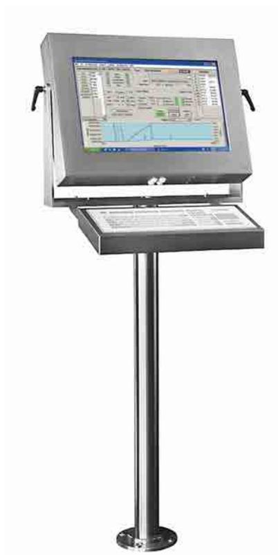
*Illustration 1 : POLARIS II Panel PC dans un caisson inox, orientable avec écran tactile, clavier avec pavé tactile intégré*
