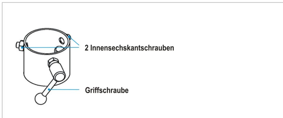
Abbildung 12: Schwenkbarer Adapter
