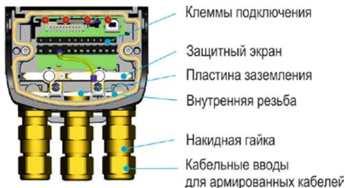
Рисунок 11: Концепция экранирования - подключаемый модуль ANTARES для армированных проводов
