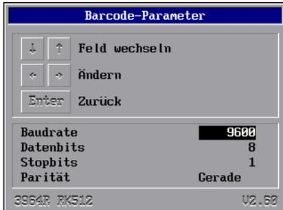
Hier sind die Schnittstellenparameter für einen Barcodescanner oder ein entsprechendes Gerät (ASCII-Zeichen) einzugeben.
