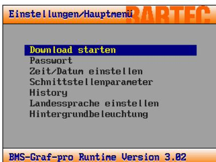
Die Einstellungen im laufenden Betrieb werden durch Drücken der „i“-Taste erreicht. Es ist ähnlich dem vorherigen Setup. Sind Störmeldungen vorhanden werden zuerst die Störmeldungen angezeigt. Durch nochmaliges Drücken der „i“-Taste wird das Setup erreicht.
