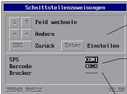
Auswahl der Schnittstelle an die die Steuerung angeschlossen wird **und** der Download erfolgt.
