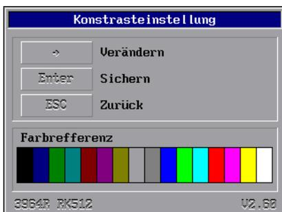
Mittels der ➡ Taste wird der Kontrast verändert. Das Anzeigeterminal wird bei gedrückter ➡ Taste erst dunkler und dann heller werden. Ist der gewünschte Kontrast erreicht, kann mittels „ESC“-Taste zurückgesprungen, oder mittels der „ENTER“-Taste der Kontrastwert gespeichert werden.
