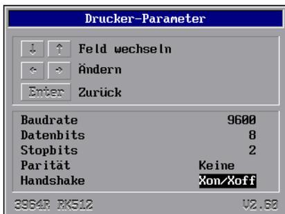
Hier sind die Schnittstellenparameter für einen seriellen Drucker einzugeben. Über diesen seriellen Drucker kann bei Bedarf der Inhalt des Histogramms als Textfile ausgedruckt werden.
