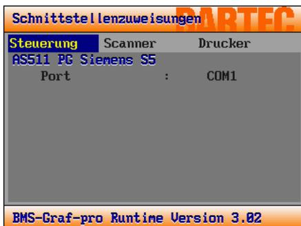
Die S5-Programmierschnittstelle hat fest definierte Parameter, die nicht verstellt werden können. Der Software muss lediglich mitgeteilt werden welche Schnittstelle am Terminal mit der Steuerung verbunden ist.
