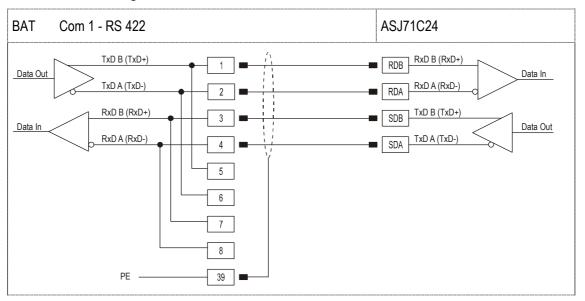
Le câblage doit absolument être réalisé avec du câble à paires torsadées. La liaison au module interface doit comprendre deux résistances de fin ligne.
