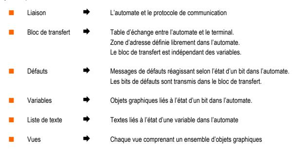
Un interpréteur déroule le programme contenu dans le terminal. L'interpréteur est dépendant du type de liaison. Il établit la liaison avec l'automate dans le protocole adéquat. L'interpréteur est téléchargé simultanément avec le projet dans le terminal.
