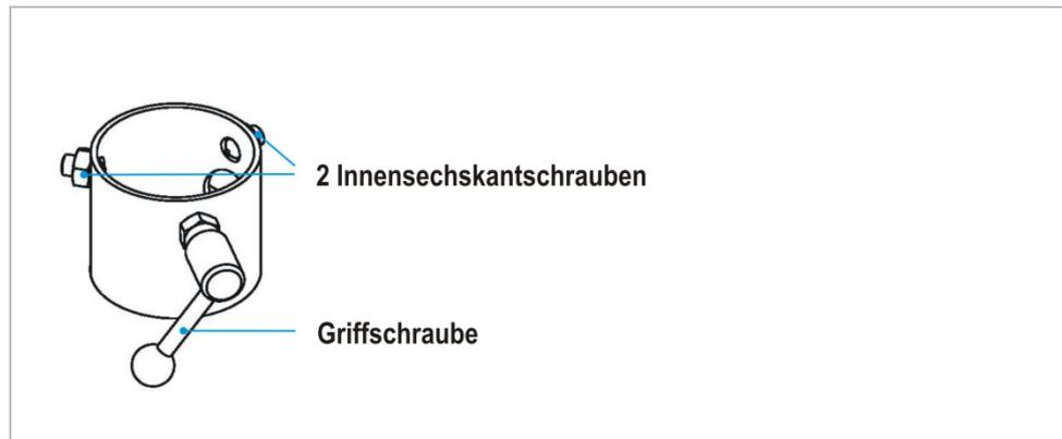
Abbildung 11: Schwenkbarer Adapter
