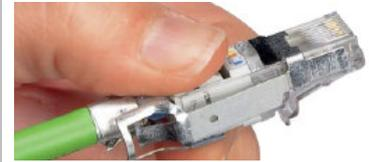
(13) Das Steckergehäuse über den Steckereinsatz führen, bis es spürbar an den Rastnasen einrastet (siehe Abbildung).
