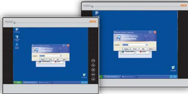
Der Bildschirm der POLARIS Web Client/Remote PC 19,1" ist ein TFT-Display mit einer SXGA-Auflösung (1280 x 1024 Bildpunkte) und der POLARIS Web Client/Remote PC 15" mit einer XGA-Auflösung (1024 x 768 Bildpunkte). Sie zeichnen sich durch hervorragend Brillanz und einem sehr großen Ablesewinkel aus.
