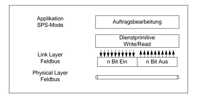
Bild: Ebenen des Kommunikationsprotokolls
